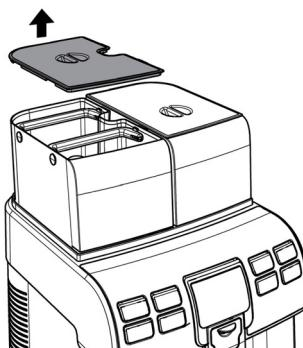
Достаньте бак; поднимите его при помощи специальных ручек, установленных внутри.
