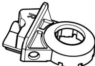
Ключ для отключения блокировки дверцы: позволяет отключить блокировку дверцы для выполнения регулировки кофемолки.
