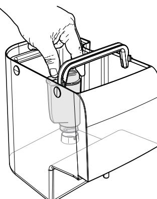
Наполните бак свежей питьевой водой и вставьте его обратно в машину.
