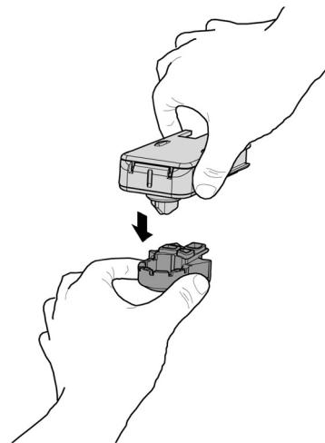
Снимите всасывающую трубку с Cappuccinatore.
