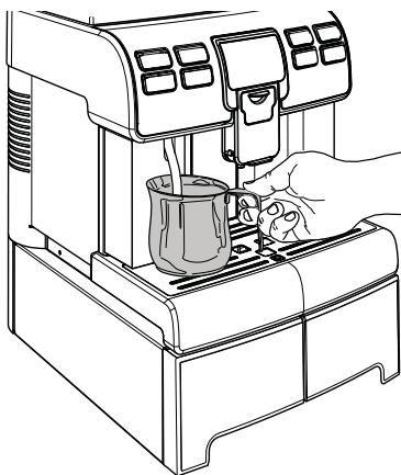
Нажмите кнопку «Горячая вода», чтобы включить подачу ГОРЯЧЕЙ ВОДЫ.
