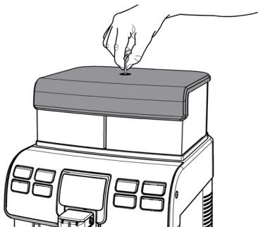
После разблокирования поднимите и снимите крышку.
