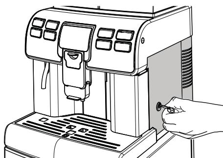
Достаньте блок приготовления кофе, для этого потянните за специальную ручку и нажмите кнопку «PRESS». Блок приготовления кофе можно мыть только теплой водой без моющего средства.
