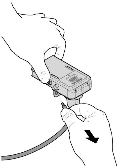
Поверните и поднимите крышку Cappuccinatore, чтобы отсоединить ее от корпуса Cappuccinatore.
