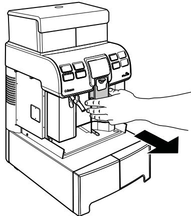
Поднимите трубку подачи горячей воды.
