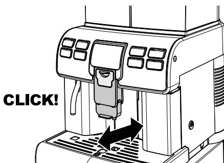
В противном случае возможно вытекание напитка из внешней части устройства подачи.
