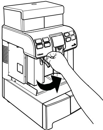
Снимите передний кожух, нажав по бокам, чтобы отсоединить крепежные фиксаторы.
