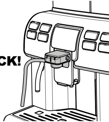
Крышку можно разместить сбоку машины с помощью вставленного в нее магнита.
