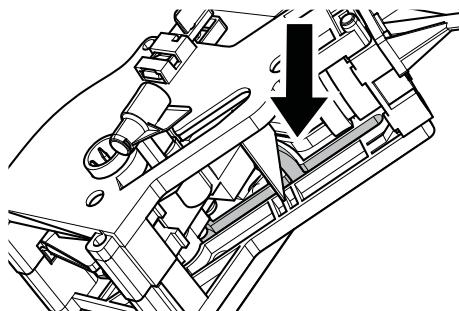
Установите заново блок приготовления кофе в специальное отделение до достижения соединения БЕЗ нажатия на кнопку «PRESS».
