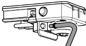
В таком случае всасывающую трубку можно вставить в крепления, как показано на рисунке.
