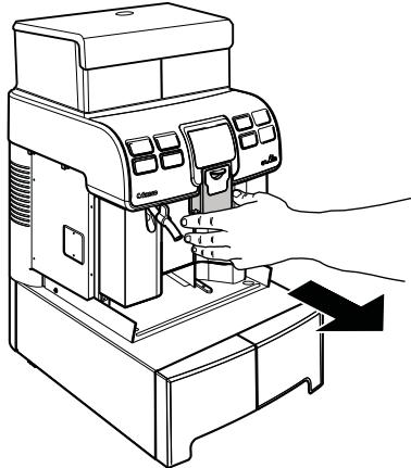
Поднимите трубку подачи горячей воды.
