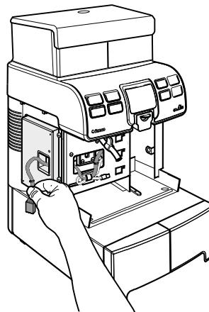
Установите проставку на левую сторону машины и закрепите ее 4 винтами из комплекта поставки.
